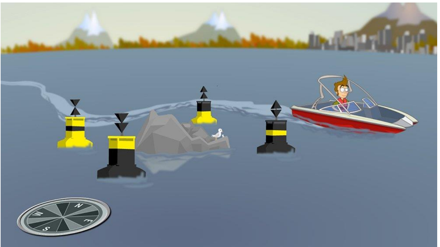
Рис.6 Пример обхода опасности за счет кардинальных знаков
