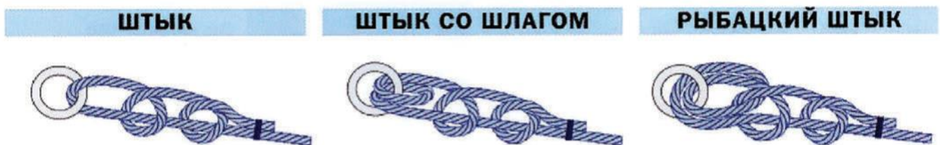
Рис.25 Морской узел (штык, штык со шлагом, рыбацкий штык)
