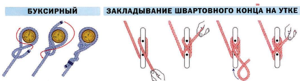
Рис.28 Морской узел (буксирный, швартовый на утке)
