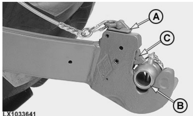
Работа с крюком зацепа через тросик управления
