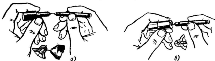
Рис. 44. Прочистка распылителя: а — сопловых отверстий; б — внутренней полости.
