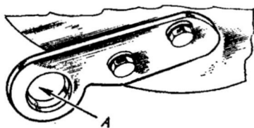
Рис. 29. Кронштейн блокировки. А — отверстие.
