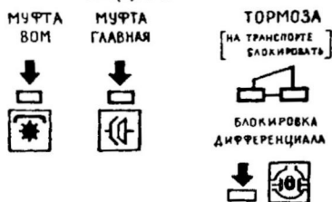
Рис. 6. Схема положений рычагов управления.
