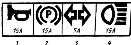
Рис. 7. Символы электроцепей плавких предохранителей:
