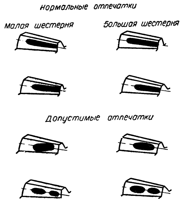
Рис. 69. Схема расположения отпечатков на зубьях конических шестерен главной передачи.
