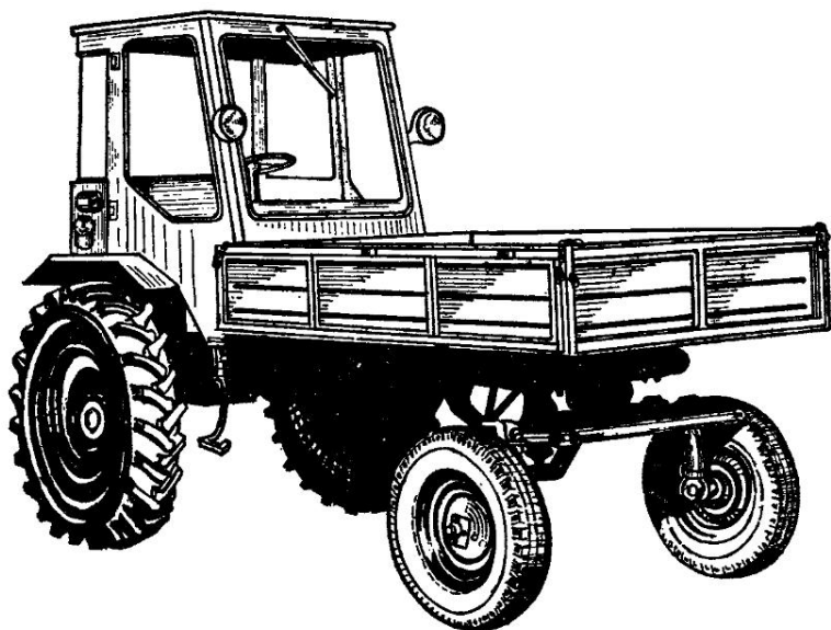
Рис. 1. Самоходное шасси Т-16М.
