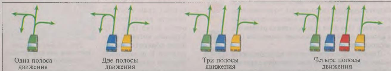
Рис. 81. Разрешенные направления движения по полосам
