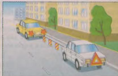
Рис. 93. Применение знака аварийной остановки при буксировке
