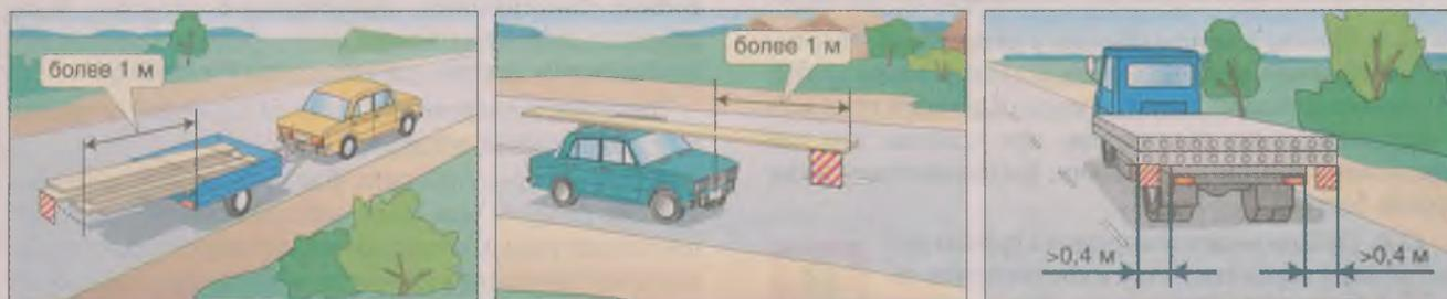
Рис. 150. Допустимые размеры перевозимого груза без обозначения опознавательными знаками
