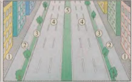
Рис. 7. Дорога с «Разделительными полосами»: 1 — тротуары; 2 и 4 — четыре проезжие части дороги; 3 и 5 — три разделительные полосы
