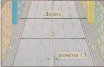
Рис. 6. Дорога без «Разделительной полосы»: 1 — тротуары; 2 — проезжая часть дороги
