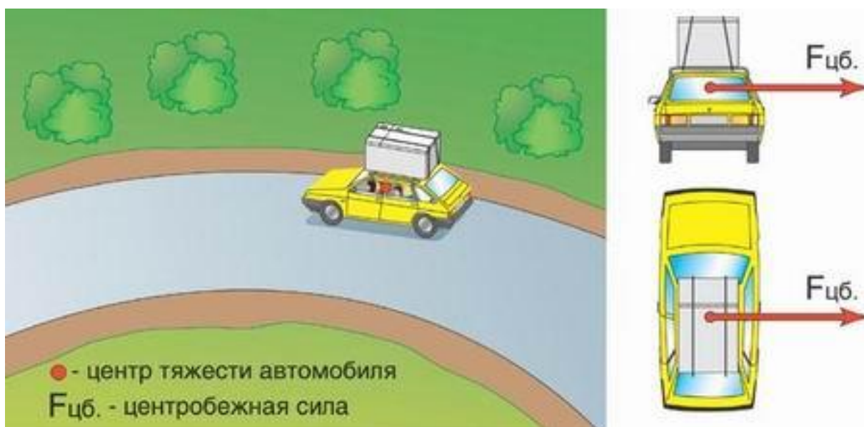
Рис. 62. Центр тяжести легкового автомобиля: а) без груза; б) с грузом
