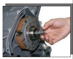
• Снимите диск сцепления при помощи специального инструмента.
