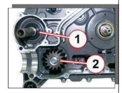
• Снимите правую половину картера двигателя при помощи специального инструмента.
