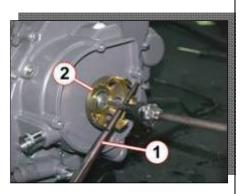
• Отвинтите болты крепления и снимите корпус магнето [3].
