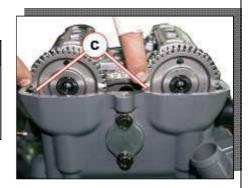
• Снимите болты крепления корпуса подшипников распредвала [1] и корпус подшипников распредвала.
