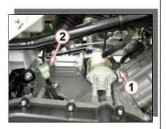
• Снимите шланги топливной системы.
