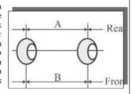
Развал — угол между вертикалью и плоскостью вращения колеса. Развал считается отрицательным, если колёса направлены верхней стороной внутрь, и положительным, если верхней стороной - наружу колес. Развал обеспечивает максимальный контакт протектора шины с поверхностью дороги при движении автомобиля и устойчивость на поворотах. Отрицательный развал улучшает устойчивость в поворотах. Положительный развал применяется лишь в двух местах:
