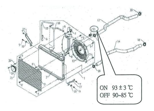
Для проверки работоспособности датчика температуры включения вентилятора подсоединяем к его контактам щупы тестера и помещаем резьбовую часть датчика в емкость с водой.
