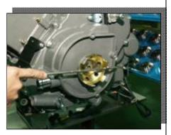
• С помощью инструмента отрегулируйте положение храповика таким образом, чтобы совместить линию ВМТ [A] с отметкой [B] на картере, чтобы перевести поршень в верхнее положение.
