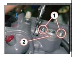
• Снимите ведомую шестерню ГРМ [1], предварительно сняв пластину оси шестерни [2], вывернув ось шестерни [3] и проставочную шайбу [4].
