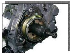
• Снимите ротор магнето при помощи специального инструмента.
