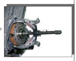
• Снимите выходной вал главной передачи [2].
