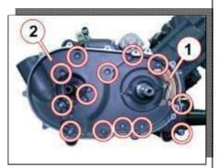
• Отвинтите болты крепления , снимите датчик включенной передачи [1].
