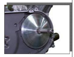
• Снимите переднюю и заднюю шлицевые муфты выходного вала двигателя.
