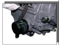
• Отвинтите болты крепления и снимите насос охлаждающей жидкости [1]
