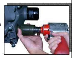
• Отвинтите болты крепления, снимите пластину направляющую обдува вариатора [1], корпус вариатора [2].
