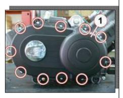
• Отвинтите болты крепления и снимите корпус подшипника вариатора [1].
