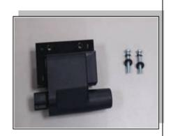
• Установите катушку зажигания, при помощи двух винтов с шайбами, в место рамы, указанное на фото.
