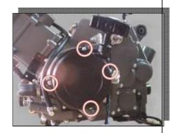
• Снимите заглушку смотрового отверстия корпуса магнето.
